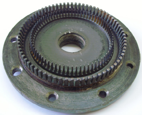
Рис. 3. Статор РПА - 6 мес. эксплуатации
