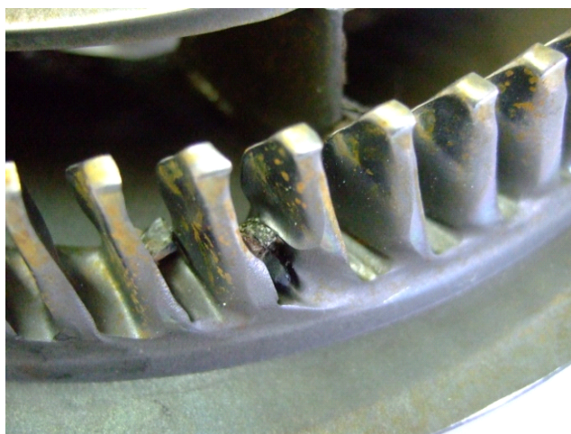
Рис. 2. Щебень в решетке ротора РПА, справа - новый
