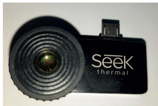
Рис. 2. Теплоконтрастная камера
